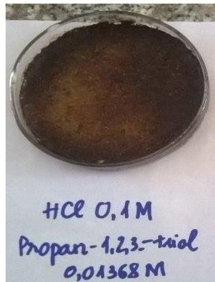
Hình 7. Sản phẩm sau khi sấy của mẫu sử dụng axit clohidric 0,1M và propan-1,2,3-triol 0,01368M
