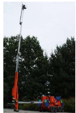
(c) Rô bốt HARS khi lắp toàn bộ phụ kiện mở rộng
