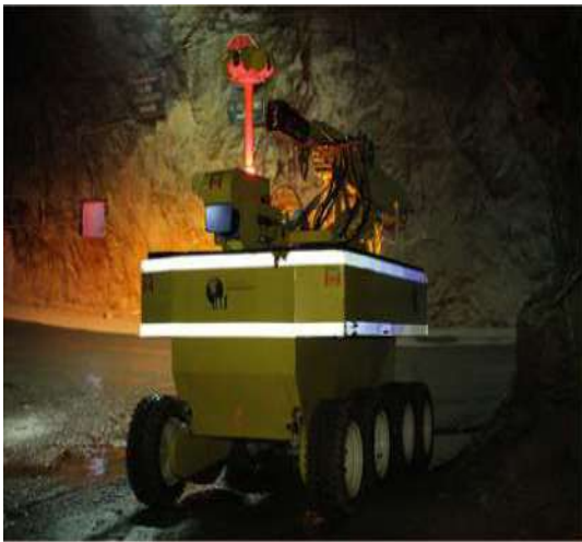
(a) Rô bốt lập bản đồ với hệ thống vị trí, định vị dưới lòng đất
