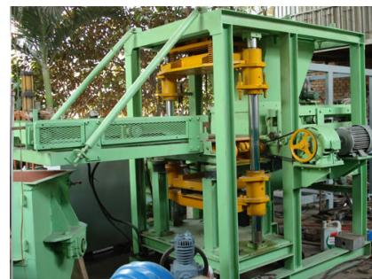
Dự án đã sản xuất thử nghiệm 10.000 viên gạch và kiểm định đạt TCVN 6477:2011; cung cấp và chuyển giao công nghệ 10 dây chuyền sản xuất gạch không nung cho các doanh nghiệp sản xuất vật liệu xây dựng ở Tây Ninh, Bình Dương, Bà Rịa - Vũng Tàu, Ninh Thuận, Quảng Nam, TP Hồ Chí Minh... Thực tế sản xuất cho thấy quy trình sản xuất được tự động hóa cao, các thiết bị trong dây chuyền dễ thao tác, ít sự cố...
