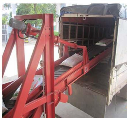
thể vận chuyển bao hàng 50 kg lên xe tải và ghe tàu với công suất 40 tấn/giờ. Hệ thống băng tải linh động được thiết kế có kết cấu vững, điều khiển không phức tạp, đảm bảo các yêu cầu kỹ thuật và phù hợp với điều kiện ứng dụng tại Việt Nam, giá chỉ bằng 30-50% sản phẩm nhập ngoại. Hệ thống đã được đưa vào sử dụng tại Xí nghiệp đường Vị Thanh (Hậu Giang) cho kết quả tốt.
