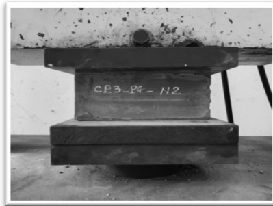
c) Sản phẩm khi thử cường độ nén
