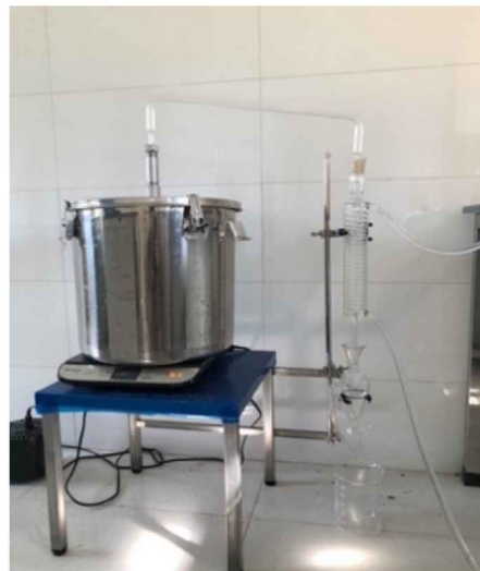
Hình 2: Bộ chưng cất lôi cuốn hơi nước tinh dầu cây mùi già Coriandrum Sativum L
