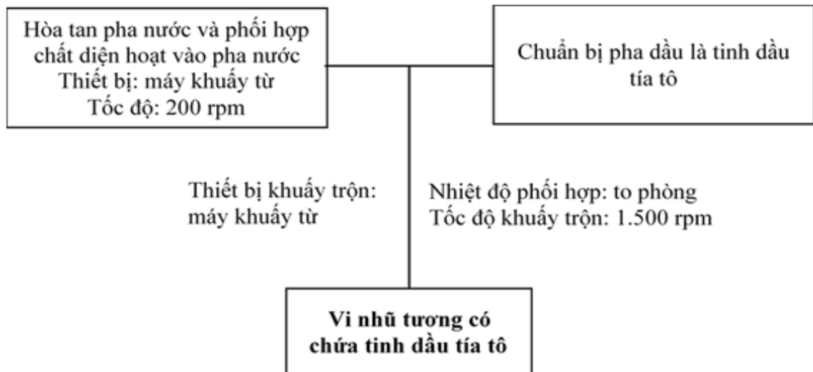
Hình 4. Sơ đồ quy trình bào chế vi nhũ tương chứa tinh dầu tía tô cỡ lô 20 ml
