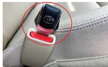
Hình 1. Sử dụng dây an toàn không đúng
