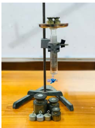
Hình 2. Bố trí thí nghiệm khảo sát định luật Boyle
