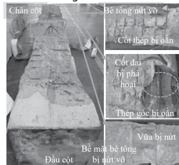
Hình 1. Phá hoại của cột BTCT do hỏa hoạn gây ra [1]
