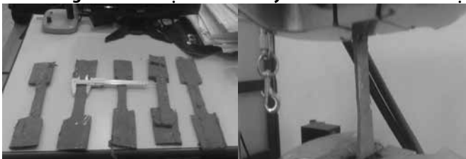
Hình 3. Mẫu thí nghiệm kéo vật liệu sơn Polyurea
