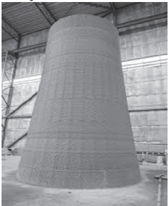
Hình 2.11. Trụ BTCT in 3D (thử nghiệm mô hình cao 10m) - [52]
