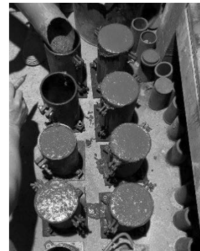
(b) Quá trình đổ UHPC.
