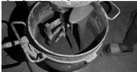
Hình 2. Thiết bị trộn cưỡng bức 4 cấp độ tại phòng thí nghiệm.
