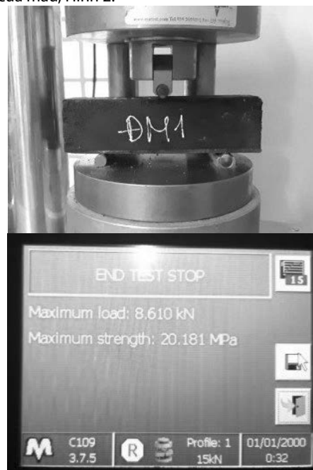
Hình 2. Đặt mẫu vào buồng uốn và kết quả uốn mẫu
