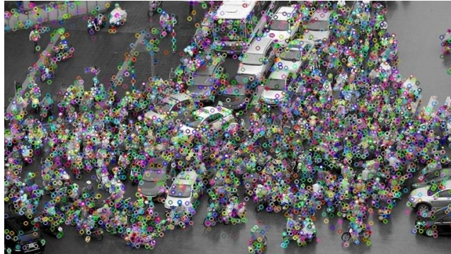
Hình 15. Trích xuất SIFT keypoint.
