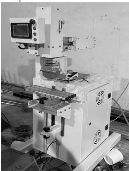
Hình 11. Sản phẩm hoàn thiện của hệ thống máy in Tampon
