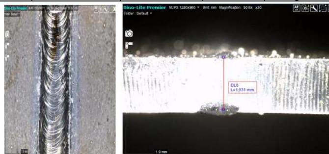
Hình 7. Vết hàn laser và độ sâu vết hàn của vật liệu thép carbon dày 2mm
