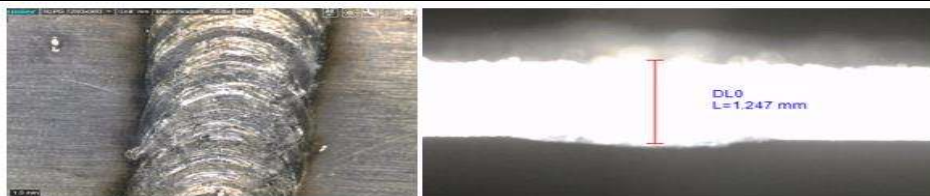
Hình 9. Vết hàn laser và độ sâu vết hàn của vật liệu nhôm dày 1mm
