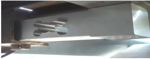
Hình 11. Loadcell gắn trên băng tải
