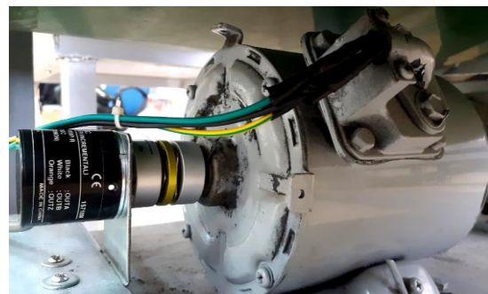
Hình 10. Encoder - động cơ
