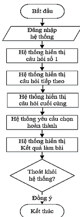
Hình 2. Lưu đồ mô tả hoạt động của hệ thống
