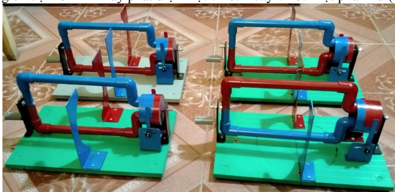
Hình 1. Mô hình máy phát điện một chiều, xoay chiều cải tiến
