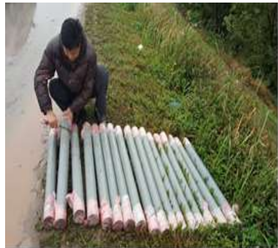
Hình 4: Công tác khoan và lấy mẫu tại hiện trường
