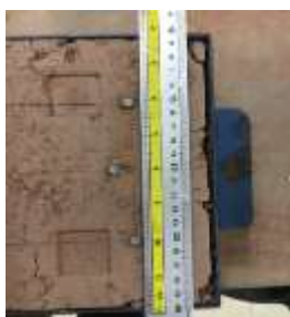
Hình 15: Vết nứt phát triển và co ngót của mẫu
