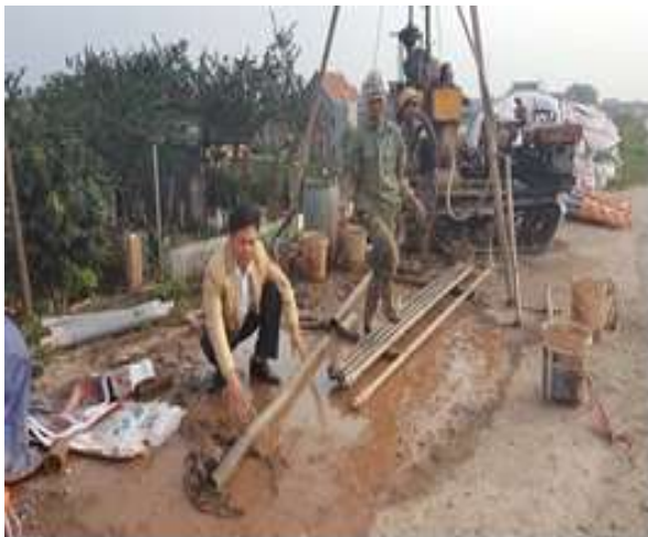
Hình 4: Công tác khoan và lấy mẫu tại hiện trường
