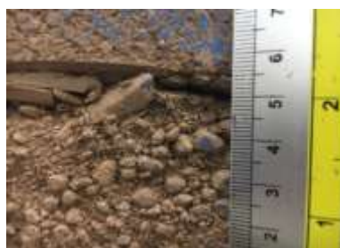
Hình 15: Vết nứt phát triển và co ngót của mẫu
