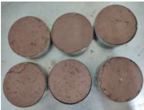
Hình 6: Mẫu đất thí nghiệm bị nứt, co ngót
