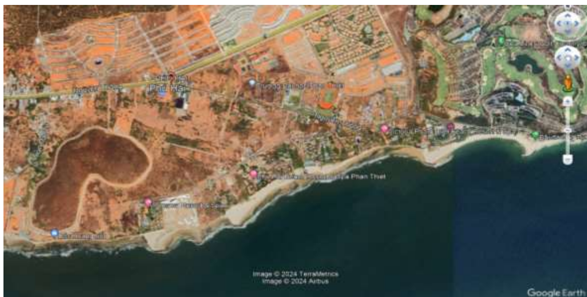
Hình 14: Hình thái đường bờ khu vực bãi tắm Romana - Cát Trắng - Phú Hải đang được hình thành các tiểu cung cong sau khi xây dựng các mỏ hàn lặn biển
