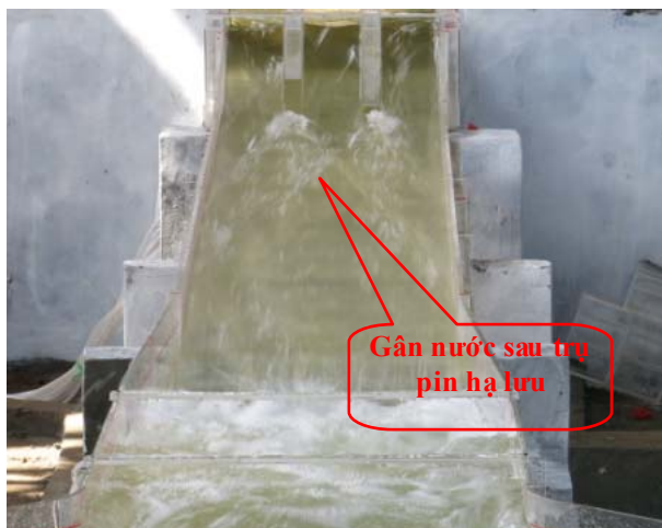
Hình 4. Giao thoa trên dốc nước
