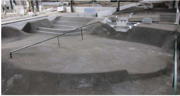
Hình 2. Mô hình hóa công trình
