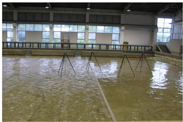
Hình 7. Sự biến đổi sóng trước và sau công trình
