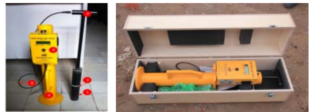
Hình 1. Thiết bị thí nghiệm CIV/882 của Viện Thủy công. (1) Búa đầm, (2) Vạch định vị chiều cao búa rơi, (3) Tay cầm, (4) Ống dẫn hướng, (5) Hộp đọc dữ liệu, (6) Dây dẫn.
