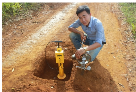
Hình 6. Hình ảnh thí nghiệm CBR và CIV tại hiện trường.
