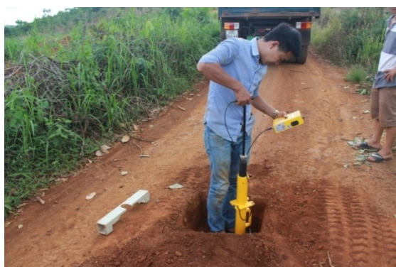
Hình 6. Hình ảnh thí nghiệm CBR và CIV tại hiện trường.
