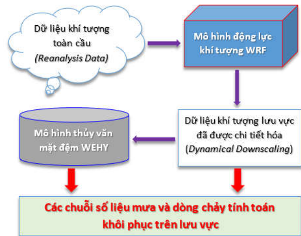
Hình 4. Quy trình tính toán khôi phục dữ liệu mưa và dòng chảy trên lưu vực bằng mô hình WEHY-WRF
