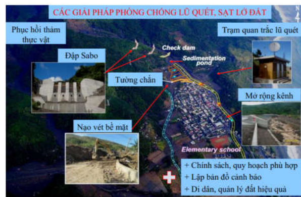
Hình 7: Sơ đồ quy hoạch các giải pháp chống lũ bùn đá cho một khu vực lũ bùn đá (Viện Nghiên cứu Thủy công, Đại học Trung ương Đài Loan)
