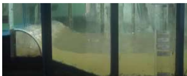
Hình 1: Mặt cắt đê có cấu kiện hình trụ rồng tại đỉnh trong máng sóng
