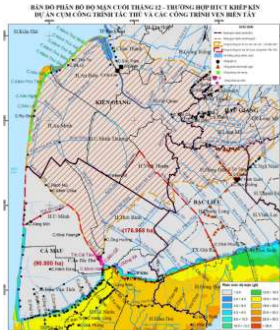
Hình 10: Diễn biến mặn cuối tháng 12 khi vận hành hệ thống cống ven biển AB-AM, cụm Tắc Thủ và QL-PH giữ ngọt
