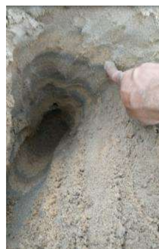
c) Hố H3 - Bùn đen tạo thành các lớp dày từ 1,0cm - 3,0cm
