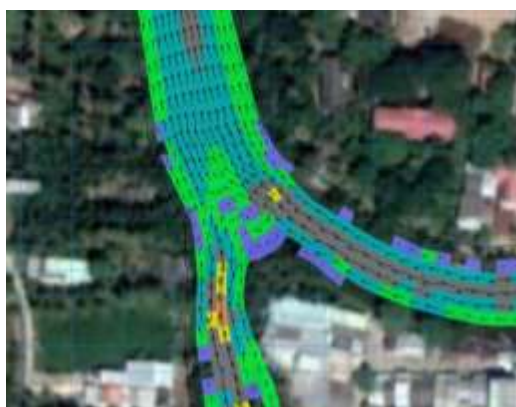
Hình 10: Hố xói xuất hiện tại khu vực ngã ba sông và thông số hình thái hai đoạn sông cong
