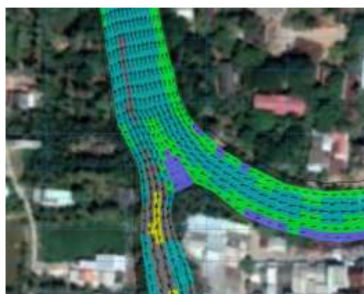
Hình 11: Kết quả mô phỏng trường vận tốc tại ngã ba sông Cầu ngang trước và sau khi lấp hố xói ngày 13/6/2018 lúc 8:00 PM và 14/6/2018 lúc 8h00 AM
