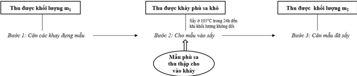
Hình 5. Sơ đồ các bước xử lý mẫu phù sa lắng đọng
