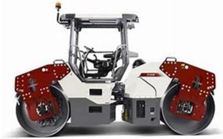
Hình 1. Hình ảnh của xe lu rung hai bánh thép
