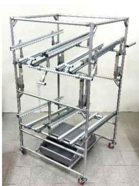
(a) Trạm cấp liệu tinh gọn
