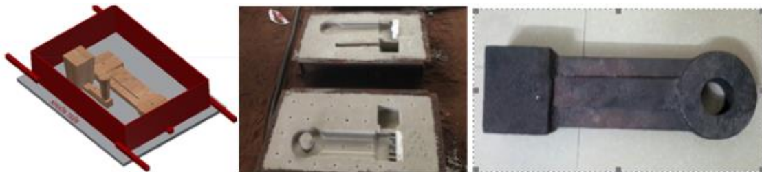
Hình 13. Khuôn thiết kế và đúc sản phẩm búa thực tế
