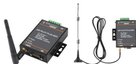
Hình 2. Bộ chuyển đổi dữ liệu của hệ thống nhận dạng tự động AIS
