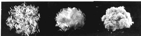
Hình 1. Một số loại sợi dùng cho vữa xi măng: Sợi polypropylene, sợi polyester, sợi xenlulo.
