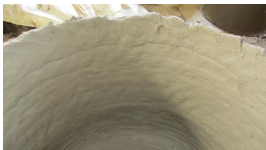
Hình 11. Những vết ghép con chạch trong lòng chum vỏ chưa được xóa hết
