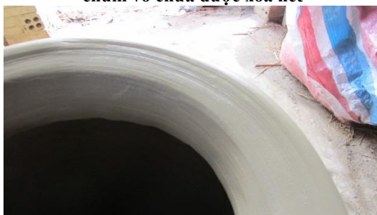
Hình 11. Những vết ghép con chạch trong lòng chum vỏ chưa được xóa hết
