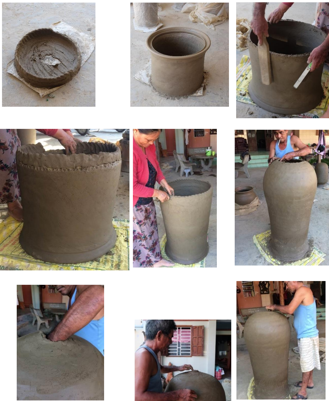
Hình 6. Thực nghiệm chum theo cách làm phần miệng trước, làm đáy sau
