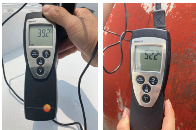
Thử nghiệm sơn phản xạ nhiệt mặt trời trên téc chứa xăng dầu tại kho 101, Cục Hậu cần, Bộ Tư lệnh Bộ đội Biên phòng, Bộ Quốc phòng (Tây Tụ, Bắc Từ Liêm, Hà Nội).
