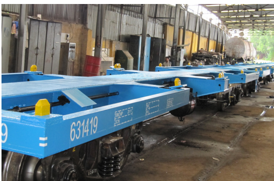
Sản phẩm được thử nghiệm sơn bảo vệ gầm toa xe khách
