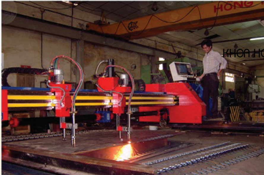
Máy cắt kim loại tấm do Viện IMI nghiên cứu, chế tạo
