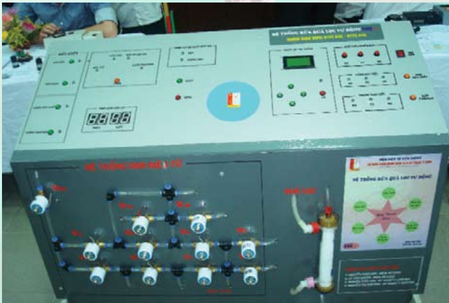
Hệ thống rửa quả lọc sử dụng cho chạy thận nhân tạo do nhóm các nhà khoa học Trường Đại học Bách khoa thiết kế, chế tạo
