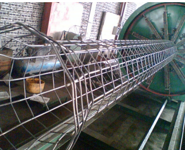
Gia công cốt thép cho ống bê tông thoát nước điều khiển CNC - Sản phẩm của Dự án KC.03.DA.09/11-15
