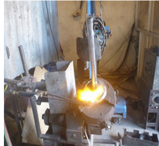
Quá trình gia nhiệt bề mặt xupap trước khi hàn
