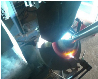
Quá trình hàn đắp xupap bằng công nghệ plasma
