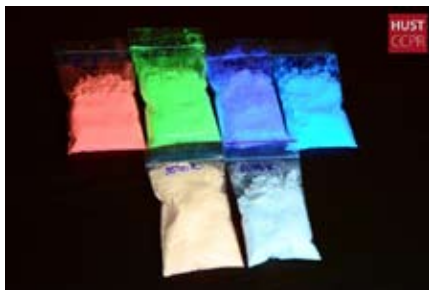
Sản phẩm nghiên cứu của Trường Đại học Bách khoa Hà Nội được ứng dụng trong chế tạo đèn huỳnh quang và huỳnh quang compact tại RALACO
