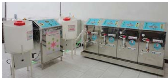
Hệ thống rửa quả lọc và dây dẫn máu tự động để tái sử dụng trong chạy thận nhân tạo BK-RQL do Viện Điện tử Y sinh nghiên cứu thiết kế và chế tạo
