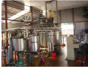
Dây chuyền pilot sản xuất nhũ tương nền công suất 14 tấn/ngày
