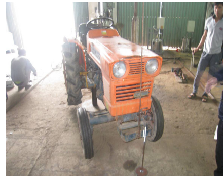
Hình 6: thí nghiệm xác định moment quán tính của máy kéo theo trục đứng
