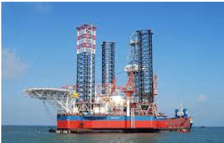
Giàn khoan tự nâng 90 m nước do các nhà khoa học trong nước nghiên cứu chế tạo
