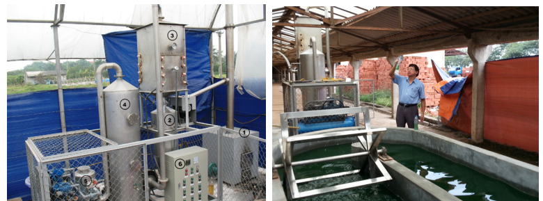
(a) Hình 1: HMĐXLKT quy mô pilot tại Cổ Nhuế (a) và Nhà máy gạch tuynel Đan Phượng, Hà Nội (b) 1- Lò đốt than; 2 - Modul khử bụi; 3- Modul hấp phụ - xúc tác; 4 - Modul phun sương; 5 - Thiết bị nạp CO 2 cao áp; 6 - Panel điều khiển hệ
