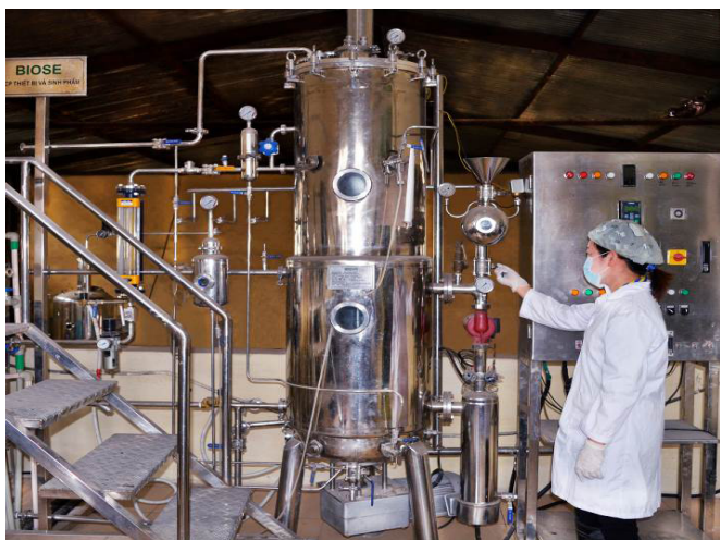
Hình 2: hệ thống lên men tự động ứng dụng trong sản xuất chế phẩm nấm men giàu selen
